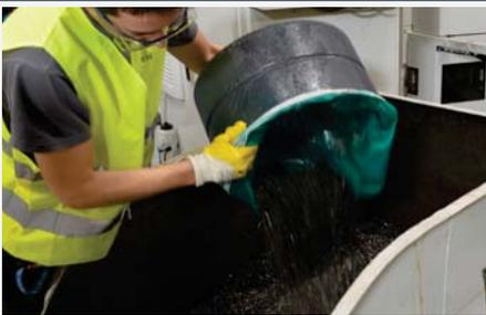
Praktische Entleerung der Späne aus dem Spänekorb oder aus dem herausnehmbaren Sammelbehälter
