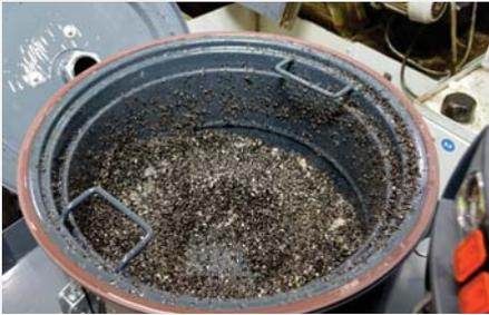
Spänekorb für die Trennung von Metallspänen und Ölen
