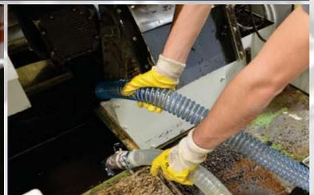
Tauchpumpe für das gleichzeitige Absaugen und Abpumpen der Flüssigkeit - „MPI“-Modelle
