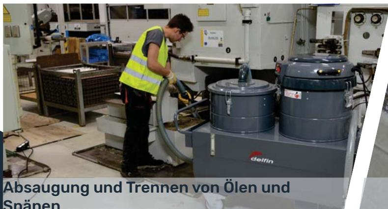
Absaugung und Trennen von Ölen und Spänen
